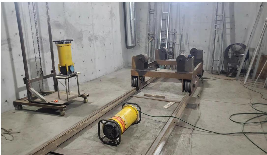
图片 5-2 X 射线探伤机现场图
