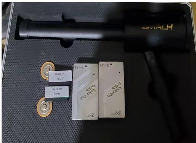
个人剂量报警仪、便携辐射巡检仪、个人剂量计
