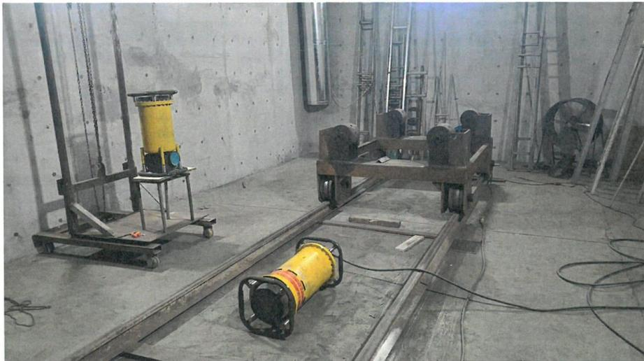
图 2 X 射线探伤机现场图
